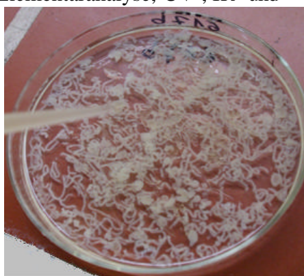
Mit Methylendiphenyldiisocyanat vernetzte Probe aus Kasein und Xylan nach Injektion ins Wasser
