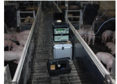
Schadgasmonitor im Läuferabteil
