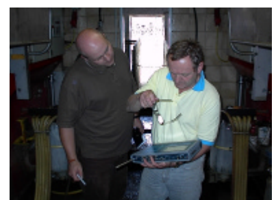
Messung der Lärmemissionen am Melkroboter
